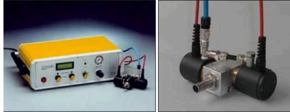
Neutraliseur d'aérosol électrostatique EAN 581 (le) ; Chambre de mélange avec têtes d'ionisation (ri)
